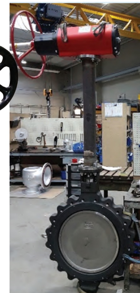
FABRICATION DE RALLONGES DE MANŒUVRE
